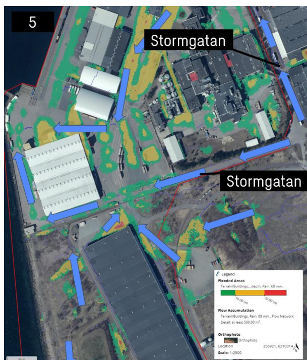
Figur 14. Kritisk punkt nummer 5 med befintliga rinnvägar (förstärkta med blå pilar) samt de lågpunkter som översvämmas vid nettotederbörd 68 mm. Färgskalan för översvämningsdjup enligt följande, grön: 0 – 10 cm, gul: 10 – 30 cm, röd: större än 30 cm.
