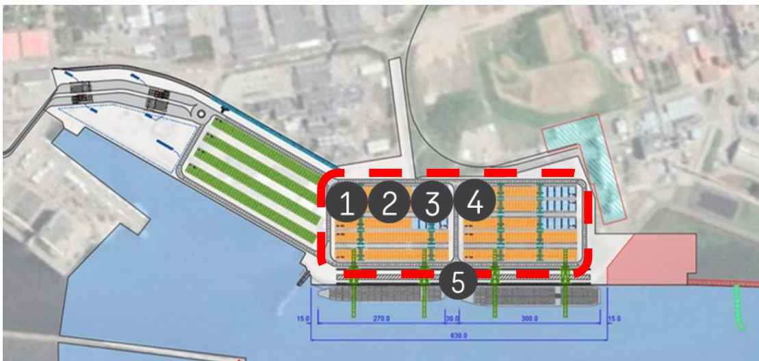
Figur 3. Layout Helsingborgs hamn ny containerterminal, identifierade brandscenarion utmärkta i bilden. Notera att scenarion 1–4 kan inträffa var som helst inom det rödstreckade området.
