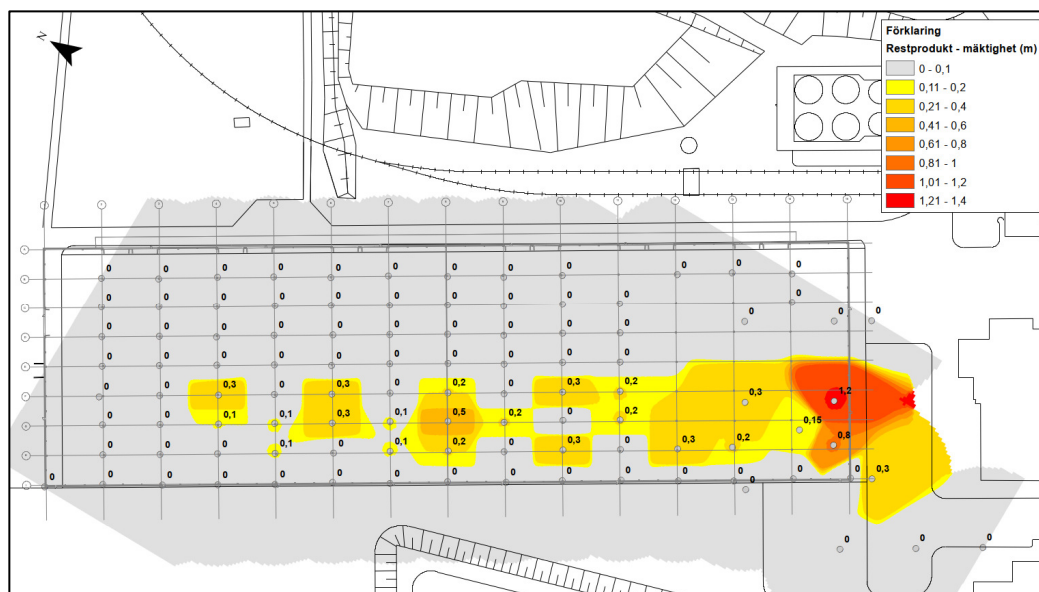
Figur 2. Uppmätta mäktigheter av "restprodukt" under Catenas byggnad (markerad med röd ram i bilaga 1) vid undersökningar utförda 2007 (WSP, 2007). Vid dem identifierades fyllnadsmaterial klassat som "restprodukt" utgöra källan till påträffade föroreningar av framförallt arsenik. Resultaten från dessa undersökningar föranledde den sanering som utfördes söder om byggnaden (WSP, 2010).
