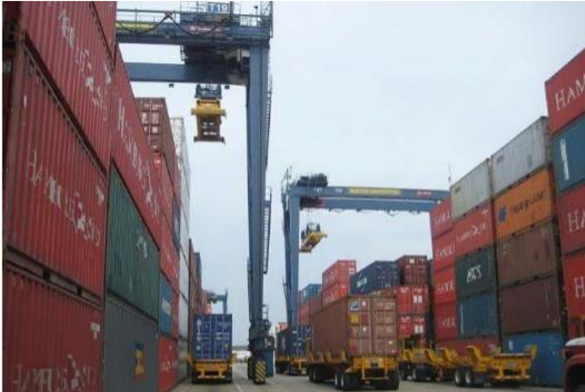
Figur 5. Hantering av containrar med RTG-kranar. Avstånden mellan raderna av containrar är jämförelsevis små.
