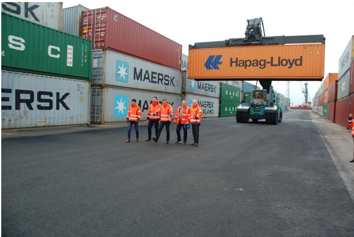
Figur 6. Hantering av containrar med truckar. Avstånden mellan raderna av containrar är jämförelsevis stora.
